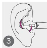
Si el acoplamiento tiene una retención conectada, insértela en el pabellón auditivo para asegurar el audífono.
